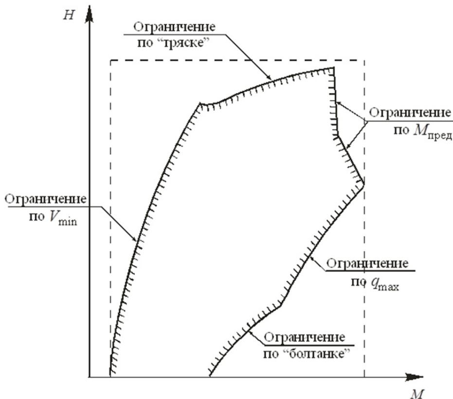
Рис. 3. Границы области эксплуатационных ограничений по высоте полета и числу Маха
