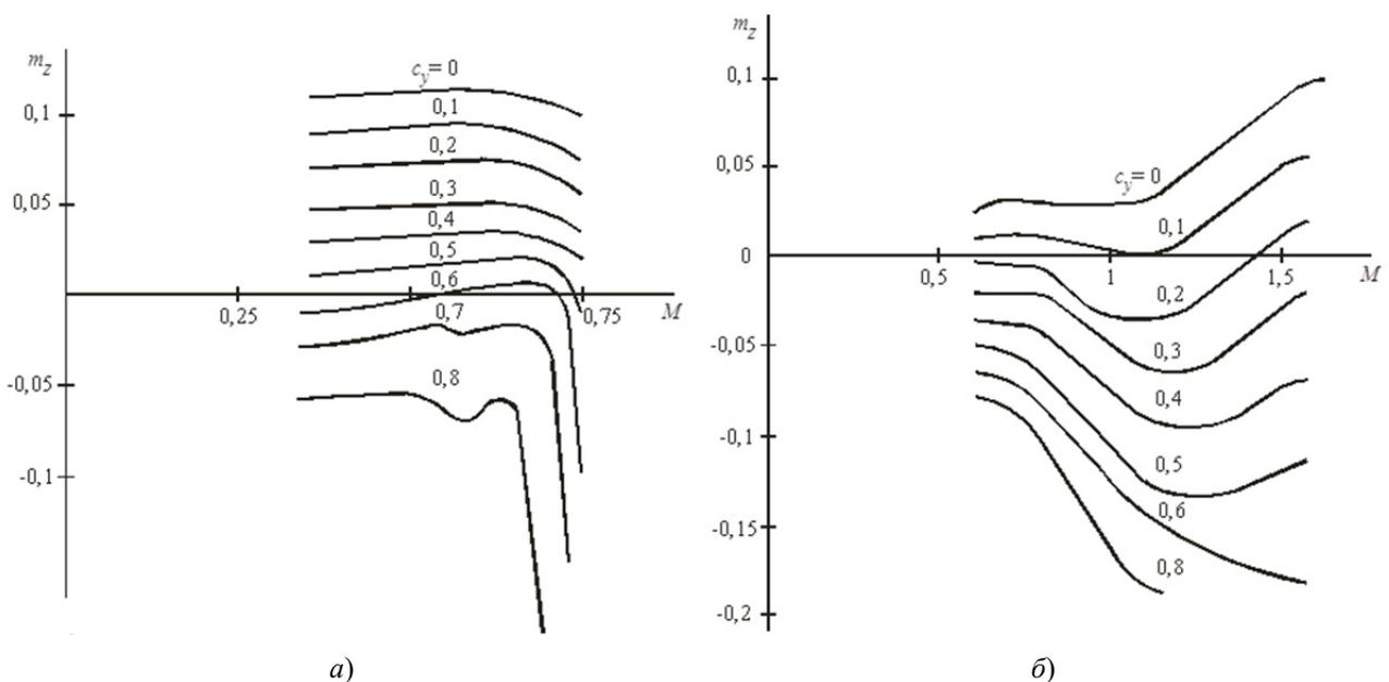
Рис. 2. Типовые характеристики  $m_z(c_y, M)$  для дозвукового (а) и сверхзвукового (б) самолетов
